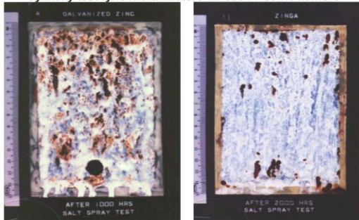
Žárové zinkování: koroze po 1000 hod. Systém ZINGA: koroze po 2000 hod.
